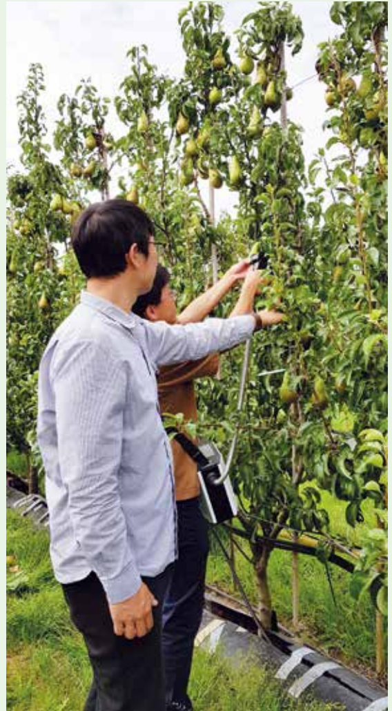
Metingen uitgevoerd met een draagbare NIR-sensor (Nabij InfraRood).
