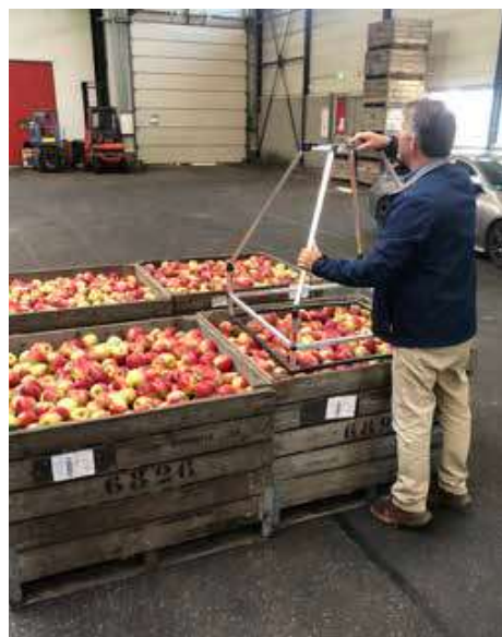
Met het smartframe is de afstand tussen camera en vruchten exact te bepalen.
